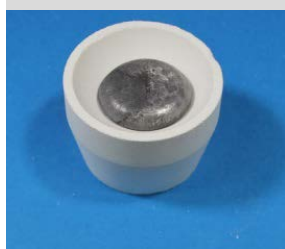
灰吹法による金・銀の分離回収
