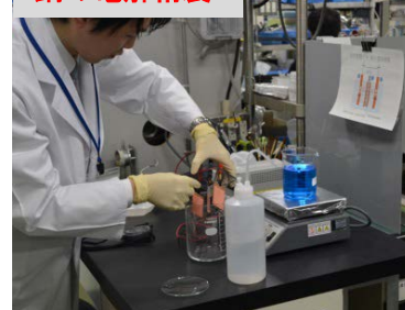
銅の電解精製
