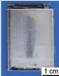
失活・解体前のLIB
